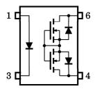
1 : ANODE 3 : CATHODE 4 : DRAIN 6 : DRAIN
