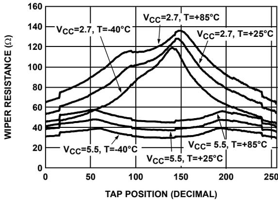
FIGURE 1. WIPER RESISTANCE vs TAP POSITION
