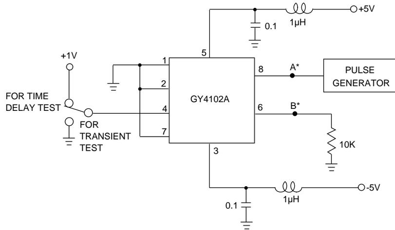
\*USE ULTRA LOW CAPACITANCE SCOPE PROBES AT POINTS A & B
