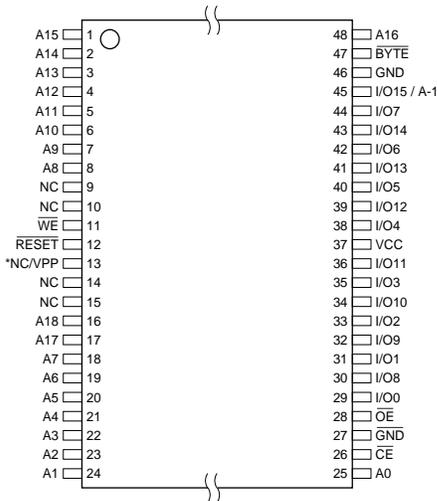
AT49BV008A(T) TSOP Top View
