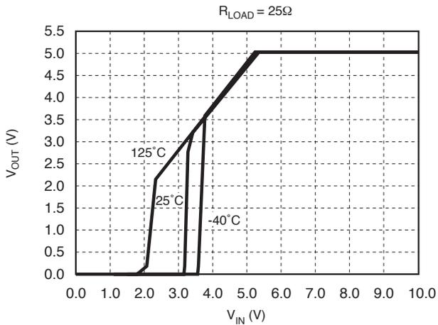
V<sub>OUT</sub> vs. V<sub>IN</sub> over R<sub>LOAD</sub>
