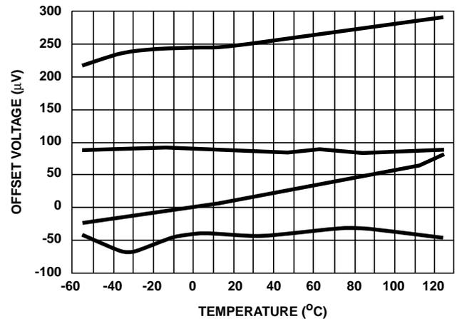
FIGURE 12. OFFSET VOLTAGE vs TEMPERATURE (4 REPRESENTATIVE UNITS)
