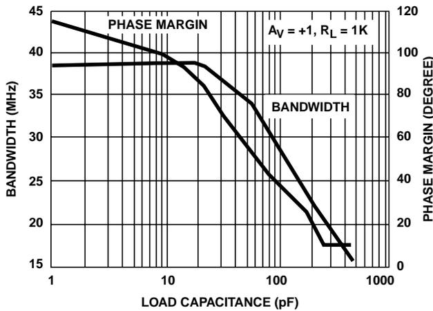
FIGURE 23. BANDWIDTH AND PHASE MARGIN vs LOAD CAPACITANCE
