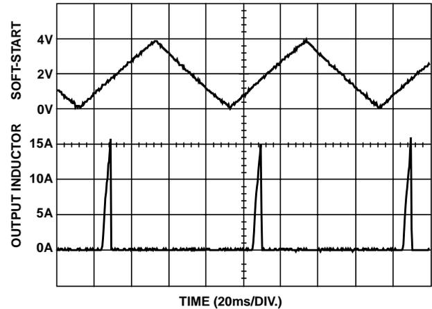
FIGURE 4. OVER-CURRENT OPERATION
