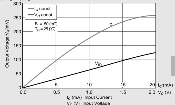
$V_{os}$ - $V_C$ ,  $V_{os}$ - $I_C$
