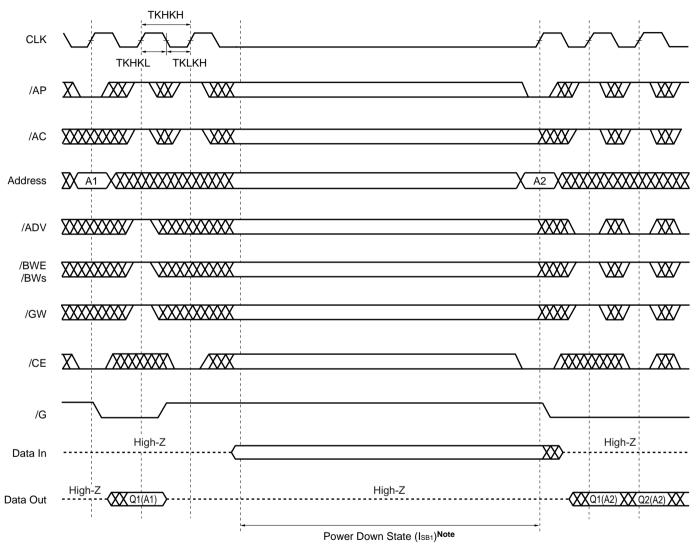
**Note**  $V_{IN} \le 0.2 \text{ V}$  or  $V_{IN} \ge V_{DD} - 0.2 \text{ V}$ ,  $V_{I/O} \le 0.2 \text{ V}$
