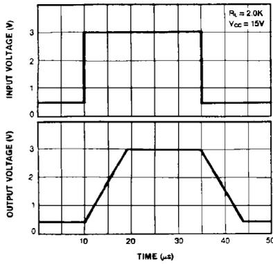
Fig. 8 VOLTAGE FOLLOWER PULSE RESPONSE (SMALL SIGNAL)
