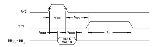
HIGH PULSE FOR  $R/\overline{C}$  - OUTPUTS ENABLED WHILE  $R/\overline{C}$  HIGH, OTHERWISE HIGH-Z
