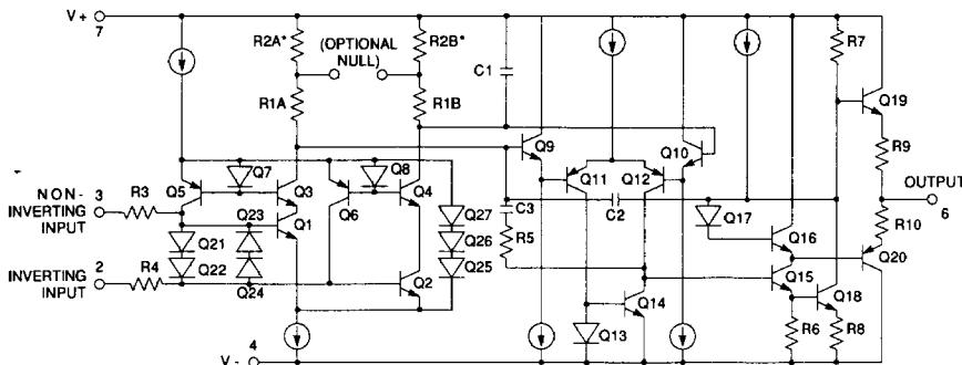
\*NOTE: R2A AND R2B ARE ELECTRONICALLY ADJUSTED ON CHIP AT FACTORY FOR MINIMUM INPUT OFFSET VOLTAGE.
