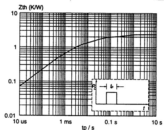
Fig.9. Transient thermal impedance per diode
