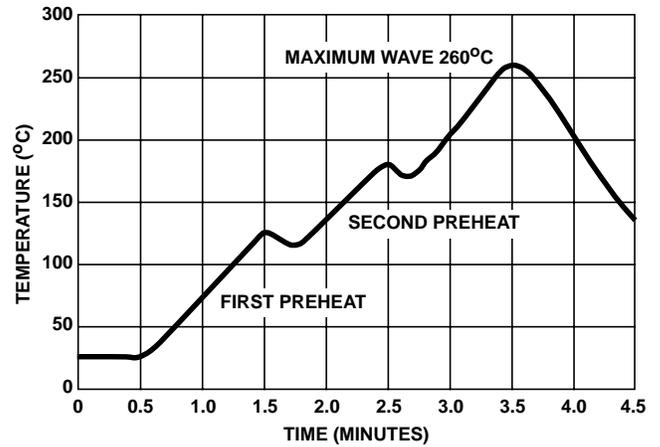
FIGURE 12. WAVE SOLDER PROFILE
