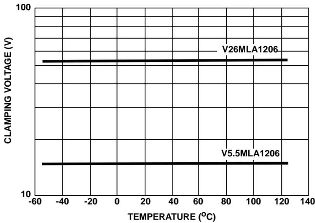
FIGURE 9. CLAMPING VOLTAGE OVER TEMPERATURE (V<sub>C</sub> AT 10A)
