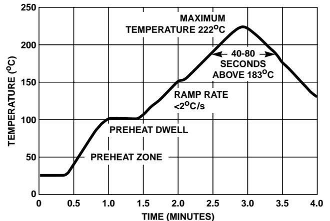
FIGURE 14. REFLOW SOLDER PROFILE
