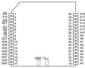
34-Pin PowerCap Module (PCM) (Uses DS9034PC PowerCap)
