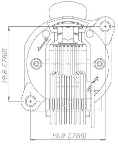
min. Einbauabstand min. assembling distance
