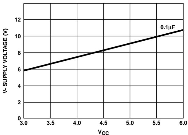
FIGURE 9. V- SUPPLY VOLTAGE vs V<sub>CC</sub>
