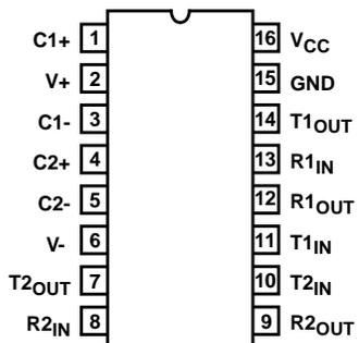
HIN232A (PDIP, SOIC, SSOP)
