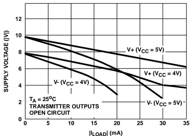
FIGURE 10. V<sub>+</sub>, V<sub>-</sub> OUTPUT VOLTAGE vs LOAD
