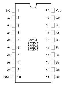
DIP/SOIC/ QSOP/TSSOP TOP VIEW
