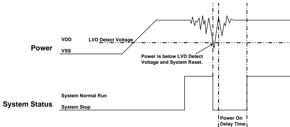
LVD(低电压检测)是 SONiX 8-bit MCU 的内置掉电复位保护装置，当 VDD 跌落并低于 LVD 检测电压值时，LVD 被触发，系统复位。不同的 MCU 有不同的 LVD 检测电平，LVD 检测电平值仅为一个点电压，并不能覆盖所有死区范围。因此采用 LVD 依赖于系统要求和环境状况。电源变化较大时，LVD 能够起到保护作用，如果电源变化触发 LVD 却使得系统工作出错，那么 LVD 就不能起到保护作用，就需要采用其它复位方法。电气特性一章中给出了更多关于 LVD 的详细内容。
