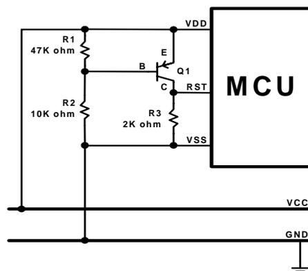
电压偏置复位电路是一种简单的 LVD 电路，基本上可以完全解决掉电复位问题。与齐纳二极管复位电路相比，这种复位电路的检测电压值的精确度有所降低。电路中，R1 和 R2 构成分压电路，当 VDD 高于和等于分压值“ $0.7V \times (R1 + R2) / R1$ ”时，三极管集电极 C 输出高电平，MCU 正常工作；VDD 低于“ $0.7V \times (R1 + R2) / R1$ ”时，集电极 C 输出低电平，MCU 复位。
