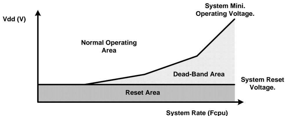
系统工作电压与执行速度关系图
