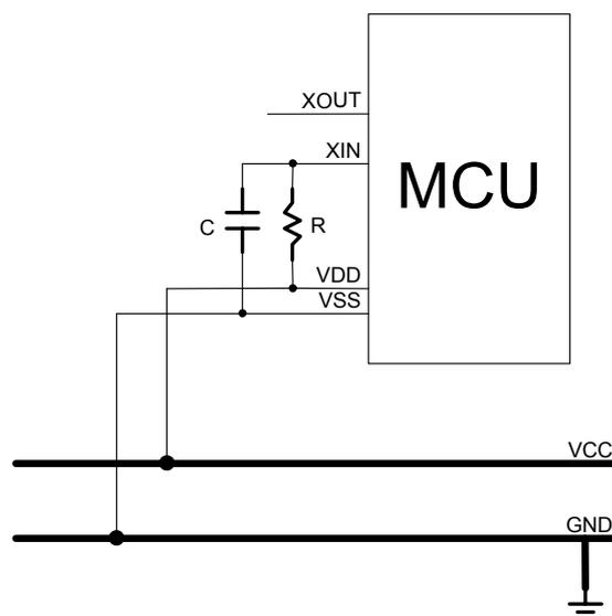
\* 注：电容 C 和电阻 R 应尽可能的接近芯片的 VDD。
