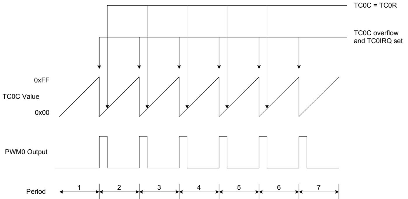
上图所示是 TC0R 恒定时的波形。每当 TC0C 溢出时，PWM 都输出高电平， $TC0C \cong TC0R$  时，PWM 即输出低电平。下面所示是 TC0R 发生变化时对应的波形图：
