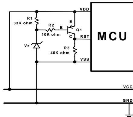
齐纳二极管复位电路是一种简单的 LVD 电路，基本上可以完全解决掉电复位问题。如上图电路中，利用齐纳管的击穿电压作为电路复位检测值，当 VDD 高于“ $V_z + 0.7V$ ”时，三极管集电极输出高电平，MCU 正常工作；当 VDD 低于“ $V_z + 0.7V$ ”时，三极管集电极输出低电平，MCU 复位。齐纳管规格不同则电路复位检测值不同，根据电路的要求选择合适的二极管。
