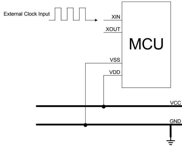
\* 注：外部振荡电路中的 GND 必须尽可能的接近芯片的 VSS 端口。
