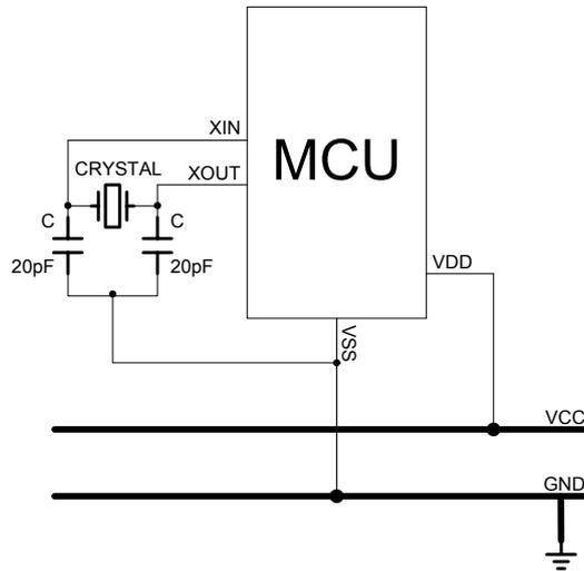
\* 注：上图中，XIN/XOUT/VSS 引脚与石英/陶瓷振荡器以及电容 C 之间的线路越短越好。
