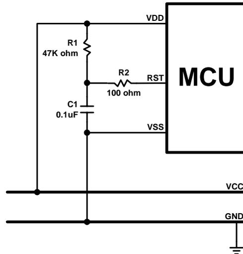
上图为一个由电阻 R1 和电容 C1 组成的基本 RC 复位电路，它在系统上电的过程中能够为复位引脚提供一个缓慢上升的复位信号。这个复位信号的上升速度低于 VDD 的上电速度，为系统提供合理的复位时间，当复位引脚达到高电平时，系统复位结束，进入正常工作状态。
