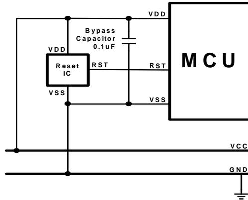
外部复位也可以选用 IC 进行外部复位，但是这样一来系统成本将会增加。针对不同的应用要求选择适当的复位 IC，如上图所示外部 IC 复位电路，能够有效的降低电源变化对系统的影响。
