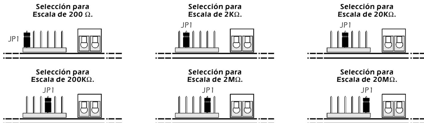
A continuación, conecte la resistencia a la entrada de medición del módulo. Observe el apartado Conexionado General. Si en algún momento supera el valor máximo de admisión de la escala, el óhmetro le indicará este hecho apagando todos los displays, excepto el último, en el que aparecerá un "1".
