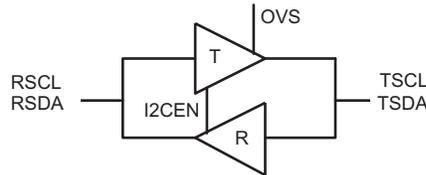
**Figure 18. I<sup>2</sup>C Drivers in TMDS141**
