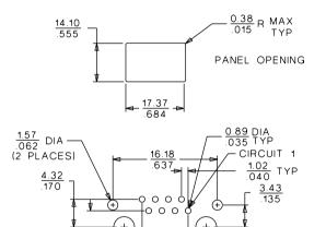
PCB LAYOUT : COMPONENT SIDE RECOMMENDED PCB THICKNESS : 1.57 .062
